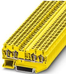
Durchgangsklemme, Nennspannung: 800 V, Nennstrom: 24 A, Anzahl der Anschlüsse: 4, Anschlussart: Zugfederanschluss, Bemessungsquerschnitt: 2,5 mm<sup>2</sup>, Querschnitt: 0,08 mm<sup>2</sup> - 4 mm<sup>2</sup>, Montageart: NS 35/7,5, NS 35/15, Farbe: gelb
