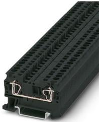
Durchgangsklemme, Nennspannung: 800 V, Nennstrom: 32 A, Anzahl der Anschlüsse: 2, Anschlussart: Zugfederanschluss, Bemessungsquerschnitt: 4 mm<sup>2</sup>, 1. Etage, Querschnitt: 0,08 mm<sup>2</sup> - 6 mm<sup>2</sup>, Montageart: NS 35/7,5, NS 35/15, Farbe: schwarz
