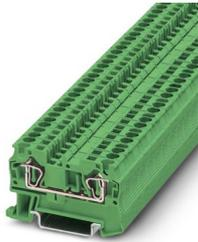
Durchgangsklemme, Nennspannung: 800 V, Nennstrom: 32 A, Anzahl der Anschlüsse: 2, Anschlussart: Zugfederanschluss, Bemessungsquerschnitt: 4 mm<sup>2</sup>, 1. Etage, Querschnitt: 0,08 mm<sup>2</sup> - 6 mm<sup>2</sup>, Montageart: NS 35/7,5, NS 35/15, Farbe: grün
