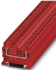
Durchgangsklemme, Nennspannung: 800 V, Nennstrom: 24 A, Anzahl der Anschlüsse: 2, Anschlussart: Zugfederanschluss, Bemessungsquerschnitt: 2,5 mm<sup>2</sup>, Querschnitt: 0,08 mm<sup>2</sup> - 4 mm<sup>2</sup>, Montageart: NS 35/7,5, NS 35/15, Farbe: rot
