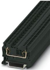
Durchgangsklemme, Nennspannung: 500 V, Nennstrom: 17,5 A, Anzahl der Anschlüsse: 2, Anschlussart: Zugfederanschluss, Bemessungsquerschnitt: 1,5 mm<sup>2</sup>, 1. Etage, Querschnitt: 0,08 mm<sup>2</sup> - 1,5 mm<sup>2</sup>, Montageart: NS 35/7,5, NS 35/15, Farbe: schwarz
