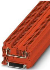
Durchgangsklemme, Nennspannung: 500 V, Nennstrom: 17,5 A, Anzahl der Anschlüsse: 2, Anschlussart: Zugfederanschluss, Bemessungsquerschnitt: 1,5 mm<sup>2</sup>, 1. Etage, Querschnitt: 0,08 mm<sup>2</sup> - 1,5 mm<sup>2</sup>, Montageart: NS 35/7,5, NS 35/15, Farbe: rot
