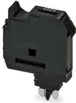
Sicherungsstecker, Vor dem Auswechseln der G-Sicherung, Sicherungsstecker aus der Grundklemme ziehen., Nennspannung: 500 V, Nennstrom: 6,3 A, Sicherungstyp: G / 5 x 20, Montageart: Steckmontage, Farbe: schwarz
