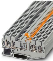
Messertrennklemme, Nennspannung: 400 V, Nennstrom: 20 A, Anschlussart: Zugfederanschluss, Bemessungsquerschnitt: 2,5 mm<sup>2</sup>, Querschnitt: 0,08 mm<sup>2</sup> - 4 mm<sup>2</sup>, Montage: NS 35/7,5, NS 35/15, Farbe: grau
