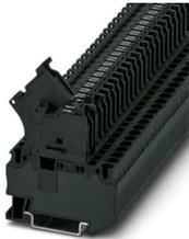
Sicherungsreihenklemme, Art der Sicherung: Glas / Keramik / ..., Sicherungstyp: G / 5 x 20, Nennspannung: 60 V, Nennstrom: 6,3 A, Anschlussart: Zugfederanschluss, 1. Etage, Bemessungsquerschnitt: 1 mm<sup>2</sup>, Querschnitt: 0,08 mm<sup>2</sup>- 6 mm<sup>2</sup>, Montageart: NS 35/7,5, NS 35/15, Farbe: schwarz
