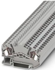
Durchgangsklemme, Nennspannung: 800 V, Nennstrom: 32 A, Anzahl der Anschlüsse: 2, Anschlussart: Zugfederanschluss, Bemessungsquerschnitt: 4 mm<sup>2</sup>, 1. Etage, Querschnitt: 0,08 mm<sup>2</sup> - 6 mm<sup>2</sup>, Montageart: NS 35/7,5, NS 35/15, Farbe: grau
