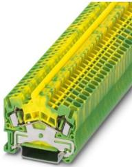
Zugfeder-Schutzleiterklemme, Anzahl der Anschlüsse: 2, Anschlussart: Zugfederanschluss, 1. Etage, Querschnitt: 0,08 mm<sup>2</sup> - 4 mm<sup>2</sup>, Montageart: NS 35/7,5, NS 35/15, Farbe: grün-gelb
