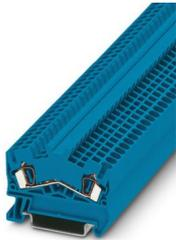
Durchgangsklemme, Nennspannung: 800 V, Nennstrom: 24 A, Anzahl der Anschlüsse: 2, Anschlussart: Zugfederanschluss, Bemessungsquerschnitt: 2,5 mm<sup>2</sup>, 1. Etage, Querschnitt: 0,08 mm<sup>2</sup> - 4 mm<sup>2</sup>, Montageart: NS 35/7,5, NS 35/15, Farbe: blau
