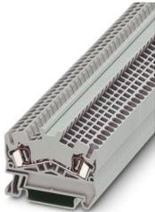
Durchgangsklemme, Nennspannung: 800 V, Nennstrom: 24 A, Anzahl der Anschlüsse: 2, Anschlussart: Zugfederanschluss, Bemessungsquerschnitt: 2,5 mm<sup>2</sup>, 1. Etage, Querschnitt: 0,08 mm<sup>2</sup> - 4 mm<sup>2</sup>, Montageart: NS 35/7,5, NS 35/15, Farbe: grau
