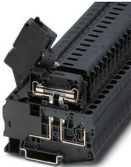
Sicherungsreihenklemme, Art der Sicherung: Glas / Keramik / ..., Sicherungstyp: G / 6,3 x 32, Nennspannung: 400 V, Nennstrom: 10 A, Anschlussart: Zugfederanschluss, 1. Etage, Bemessungsquerschnitt: 1,5 mm<sup>2</sup>, Querschnitt: 0,08 mm<sup>2</sup>- 6 mm<sup>2</sup>, Montageart: NS 35/7,5, NS 35/15, Farbe: schwarz
