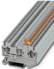
Messertrennklemme, Nennspannung: 400 V, Nennstrom: 20 A, Anschlussart: Zugfederanschluss, Bemessungsquerschnitt: 2,5 mm<sup>2</sup>, Querschnitt: 0,08 mm<sup>2</sup> - 4 mm<sup>2</sup>, Montage: NS 35/7,5, NS 35/15, Farbe: grau
