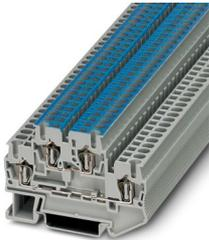
Doppelstock-Zugfederklemme, Nennspannung: 500 V, Nennstrom: 22 A, Anschlussart: Zugfederanschluss, 1. und 2. Etage, Bemessungsquerschnitt: 2,5 mm<sup>2</sup>, Querschnitt: 0,08 mm<sup>2</sup> - 4 mm<sup>2</sup>, Montageart: NS 35/7,5, NS 35/15, Farbe: grau
