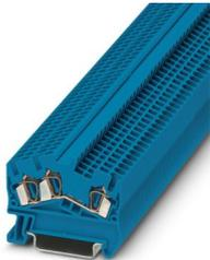
Durchgangsklemme, Nennspannung: 800 V, Nennstrom: 24 A, Anzahl der Anschlüsse: 3, Anschlussart: Zugfederanschluss, Bemessungsquerschnitt: 2,5 mm<sup>2</sup>, 1. Etage, Querschnitt: 0,08 mm<sup>2</sup> - 4 mm<sup>2</sup>, Montageart: NS 35/7,5, NS 35/15, Farbe: blau
