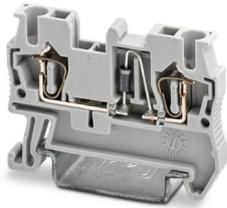
Bauelementreihenklemme, mit integrierter Diode 1N4007, Nennstrom: 0,5 A, Anschlussart: Zugfederanschluss, Bemessungsquerschnitt: 2,5 mm<sup>2</sup>, Querschnitt: 0,08 mm<sup>2</sup> - 4 mm<sup>2</sup>, Montage: NS 35/7,5, NS 35/15, Farbe: grau
