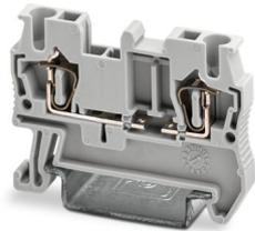
Durchgangsklemme, zum Einbau von selbst wählbaren Bauelementen, Nennspannung: 800 V, Nennstrom: 24 A, Anzahl der Anschlüsse: 2, Anschlussart: Zugfederanschluss, Bemessungsquerschnitt: 2,5 mm<sup>2</sup>, 1. Etage, Querschnitt: 0,08 mm<sup>2</sup> - 4 mm<sup>2</sup>, Montageart: NS 35/7,5, NS 35/15, Farbe: grau
