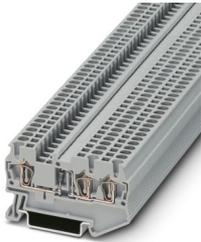
Bauelementreihenklemme, mit integrierter Diode 1N4007, Nennstrom: 0,5 A, Anzahl der Anschlüsse: 3, Anschlussart: Zugfederanschluss, Bemessungsquerschnitt: 2,5 mm<sup>2</sup>, Querschnitt: 0,08 mm<sup>2</sup> - 4 mm<sup>2</sup>, Montageart: NS 35/7,5, NS 35/15, Farbe: grau
