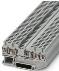
Bauelementreihenklamme, mit integrierter Diode, Nennspannung: 800 V, Nennstrom: 0,5 A, Anschlussart: Zugfederanschluss, Bemessungsquerschnitt: 1 mm<sup>2</sup>, Querschnitt: 0,08 mm<sup>2</sup> - 4 mm<sup>2</sup>, Montage: NS 35/7,5, NS 35/15, Farbe: grau
