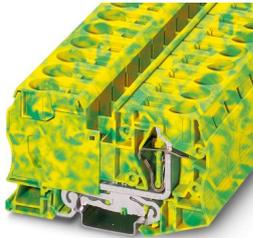
Schutzleiterklemme, Nennspannung: 1000 V, Nennstrom: 125 A, Anzahl der Anschlüsse: 2, Anschlussart: Zugfederanschluss, 1. Etage, Bemessungsquerschnitt: 35 mm<sup>2</sup>, Querschnitt: 2,5 mm<sup>2</sup> - 35 mm<sup>2</sup>, Montageart: NS 35/7,5, NS 35/15, Farbe: grün-gelb
