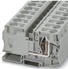
Durchgangsklemme, Nennspannung: 1000 V, Nennstrom: 125 A, Anzahl der Anschlüsse: 2, Anschlussart: Zugfederanschluss, Bemessungsquerschnitt: 35 mm<sup>2</sup>, 1. Etage, Querschnitt: 2,5 mm<sup>2</sup> - 35 mm<sup>2</sup>, Montageart: NS 35/7,5, NS 35/15, Farbe: grau
