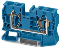
Durchgangsklemme, Nennspannung: 1000 V, Nennstrom: 76 A, Anzahl der Anschlüsse: 2, Anschlussart: Zugfederanschluss, Bemessungsquerschnitt: 16 mm<sup>2</sup>, Querschnitt: 0,2 mm<sup>2</sup> - 25 mm<sup>2</sup>, Montageart: NS 35/7,5, NS 35/15, Farbe: blau
