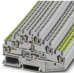
Mehrstockklemme, Nennspannung: 500 V, Nennstrom: 22 A, Anzahl der Anschlüsse: 6, Anschlussart: Zugfederanschluss, Bemessungsquerschnitt: 2,5 mm<sup>2</sup>, 1., 2. und 3. Etage, Querschnitt: 0,08 mm<sup>2</sup> - 4 mm<sup>2</sup>, Montageart: NS 35/7,5, NS 35/15, Farbe: grau
