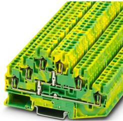
Zugfeder-Schutzleiterklemme, Anzahl der Anschlüsse: 6, Anschlussart: Zugfederanschluss, 1., 2. und 3. Etage, Querschnitt:  $0,08 \text{ mm}^2 - 4 \text{ mm}^2$ , Montageart: NS 35/7,5, NS 35/15, Farbe: grün-gelb
