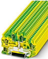
Schutzleiter-Doppelstockklemme, Anzahl der Anschlüsse: 4, Anschlussart: Zugfederanschluss, Bemessungsquerschnitt: 2,5 mm<sup>2</sup>, Querschnitt: 0,08 mm<sup>2</sup> - 4 mm<sup>2</sup>, Montageart: NS 35/7,5, NS 35/15, Farbe: grün-gelb
