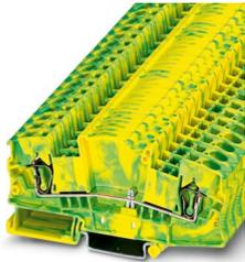
Schutzleiter-Reihenklemme, Anzahl der Anschlüsse: 2, Anschlussart: Zugfederanschluss, Querschnitt: 0,2 mm<sup>2</sup> - 10 mm<sup>2</sup>, Montageart: NS 35/7,5, NS 35/15, Farbe: grün-gelb
