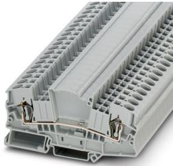
Durchgangsklemme, Nennspannung: 1000 V, Nennstrom: 41 A, Anzahl der Anschlüsse: 2, Anschlussart: Zugfederanschluss, Bemessungsquerschnitt: 6 mm<sup>2</sup>, Querschnitt: 0,2 mm<sup>2</sup> - 10 mm<sup>2</sup>, Montageart: NS 35/7,5, NS 35/15, Farbe: grau
