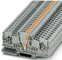
Messwandler-Trennklemme, Nennspannung: 500 V, Nennstrom: 30 A, Anzahl der Anschlüsse: 2, Anschlussart: Zugfederanschluss, Bemessungsquerschnitt: 6 mm<sup>2</sup>, Querschnitt: 0,2 mm<sup>2</sup> - 10 mm<sup>2</sup>, Montageart: NS 35/7,5, NS 35/15, Farbe: grau
