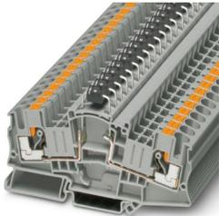
Bauelementreihenklemme, Werden mehrere Diodenklemmen auf der Tragschiene aneinandergereiht muss eine Distanzplatte dazwischen gesetzt werden., mit integrierter Diode P1000M, Nennspannung: 1000 V, Nennstrom: 5 A, Anschlussart: Push-in-Anschluss, 1. Etage, Bemessungsquerschnitt: 6 mm<sup>2</sup>, Querschnitt: 0,5 mm<sup>2</sup> - 10 mm<sup>2</sup>, Farbe: grau
