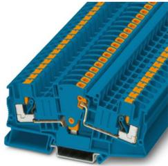
Messwandler-Trennklemme, Nennspannung: 1000 V, Nennstrom: 30 A, Anzahl der Anschlüsse: 2, Anschlussart: Push-in-Anschluss, Bemessungsquerschnitt: 6 mm<sup>2</sup>, 1. Etage, Querschnitt: 0,5 mm<sup>2</sup> - 10 mm<sup>2</sup>, Montageart: NS 35/15, NS 35/7,5, Farbe: blau
