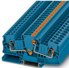
Messwandler-Trennklemme, Nennspannung: 1000 V, Nennstrom: 30 A, Anschlussart: Zugfederanschluss, Bemessungsquerschnitt: 6 mm<sup>2</sup>, Querschnitt: 0,2 mm<sup>2</sup> - 10 mm<sup>2</sup>, Farbe: blau
