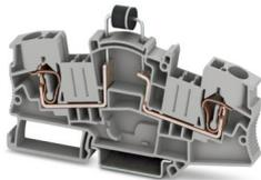
Bauelementreihenklemme, Werden mehrere Diodenklemmen auf der Tragschiene aneinandergereiht muss eine Distanzplatte dazwischen gesetzt werden., mit integrierter Diode P1000M, Nennspannung: 1000 V, Nennstrom: 5 A, Anschlussart: Zugfederanschluss, Bemessungsquerschnitt: 6 mm<sup>2</sup>, Querschnitt: 0,2 mm<sup>2</sup> - 10 mm<sup>2</sup>, Farbe: grau
