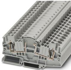
Bauelementreihenklemme, Werden mehrere Diodenklemmen auf der Tragschiene aneinandergereiht muss eine Distanzplatte dazwischen gesetzt werden., zum Einbau von selbst wählbaren Bauelementen, Nennspannung: 500 V, Nennstrom: 30 A, Anschlussart: Zugfederanschluss, Bemessungsquerschnitt: 6 mm<sup>2</sup>, Querschnitt: 0,2 mm<sup>2</sup> - 10 mm<sup>2</sup>, Farbe: grau
