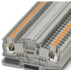
Bauelementreihenklemme, zum Einbau von selbst wählbaren Bauelementen, Nennspannung: 500 V, Nennstrom: 30 A, Anschlussart: Push-in-Anschluss, 1. Etage, Bemessungsquerschnitt: 6 mm<sup>2</sup>, Querschnitt: 0,5 mm<sup>2</sup> - 10 mm<sup>2</sup>, Farbe: grau
