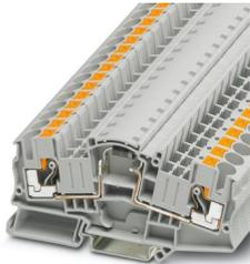
Bauelementreihenklemme, Werden mehrere Diodenklemmen auf der Tragschiene aneinandergereiht muss eine Distanzplatte dazwischen gesetzt werden., mit integrierter Diode BY255, Nennstrom: 1,5 A, Anschlussart: Push-in-Anschluss, 1. Etage, Bemessungsquerschnitt: 6 mm<sup>2</sup>, Querschnitt: 0,5 mm<sup>2</sup> - 10 mm<sup>2</sup>, Farbe: grau
