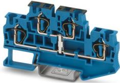
Doppelstockklemme, mit Potenzialverbinder, Nennspannung: 500 V, Nennstrom: 30 A, Anschlussart: Zugfederanschluss, 1. und 2. Etage, Bemessungsquerschnitt: 4 mm<sup>2</sup>, Querschnitt: 0,08 mm<sup>2</sup> - 6 mm<sup>2</sup>, Montageart: NS 35/7,5, NS 35/15, Farbe: blau
