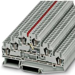
Mehrstockklemme, Nennspannung: 500 V, Nennstrom: 20 A, Anzahl der Anschlüsse: 6, Anschlussart: Zugfederanschluss, Bemessungsquerschnitt: 2,5 mm<sup>2</sup>, 1., 2. und 3. Etage, Querschnitt: 0,08 mm<sup>2</sup> - 4 mm<sup>2</sup>, Montageart: NS 35/7,5, NS 35/15, Farbe: grau
