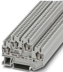
Doppelstock-Zugfederklemme, zum Einbau von selbst wählbaren Bauelementen, Nennspannung: 500 V, Nennstrom: 22 A, 1. und 2. Etage, Anschlussart: Zugfederanschluss, Bemessungsquerschnitt: 2,5 mm<sup>2</sup>, Querschnitt: 0,08 mm<sup>2</sup> - 4 mm<sup>2</sup>, Montage: NS 35/7,5, NS 35/15, Farbe: grau
