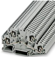
Trennklemme, Strom und Spannung werden durch den eingesetzten Stecker bestimmt., Nennspannung: 500 V, Thermischer Dauerstrom  $I_{th}$ : 28 A, Anschlussart: Zugfederanschluss, Bemessungsquerschnitt: 4 mm<sup>2</sup>, Querschnitt: 0,08 mm<sup>2</sup> - 6 mm<sup>2</sup>, Querschnitt: 0,08 mm<sup>2</sup> - 6 mm<sup>2</sup>, Montageart: NS 35/7,5, NS 35/15, Farbe: grau
