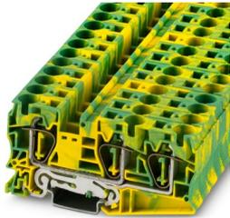
Schutzleiter-Reihenklemme, Anzahl der Anschlüsse: 3, Anschlussart: Zugfederanschluss, Bemessungsquerschnitt: 16 mm<sup>2</sup>, Querschnitt: 0,2 mm<sup>2</sup> - 25 mm<sup>2</sup>, Montageart: NS 35/15, NS 35/7,5, Farbe: grün-gelb
