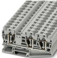
Durchgangsklemme, Nennspannung: 1000 V, Nennstrom: 76 A, Anzahl der Anschlüsse: 3, Anschlussart: Zugfederanschluss, Bemessungsquerschnitt: 16 mm<sup>2</sup>, Querschnitt: 0,2 mm<sup>2</sup> - 25 mm<sup>2</sup>, Montageart: NS 35/15, NS 35/7,5, Farbe: grau
