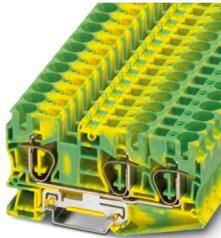
Zugfeder-Schutzleiterklemme, Anzahl der Anschlüsse: 3, Anschlussart: Zugfederanschluss, 1. Etage, Bemessungsquerschnitt: 10 mm<sup>2</sup>, Querschnitt: 0,2 mm<sup>2</sup> - 16 mm<sup>2</sup>, Montageart: NS 35/7,5, NS 35/15, Farbe: grün-gelb
