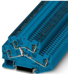
Doppelstockklemme, mit Potenzialverbinder, Nennspannung: 500 V, Nennstrom: 22 A, Anschlussart: Zugfederanschluss, 1. und 2. Etage, Bemessungsquerschnitt: 2,5 mm<sup>2</sup>, Querschnitt: 0,08 mm<sup>2</sup> - 4 mm<sup>2</sup>, Montageart: NS 35/7,5, NS 35/15, Farbe: blau
