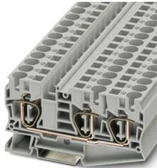
Durchgangsklemme, Nennspannung: 1000 V, Nennstrom: 57 A, Anzahl der Anschlüsse: 3, Anschlussart: Zugfederanschluss, Bemessungsquerschnitt: 10 mm<sup>2</sup>, 1. Etage, Querschnitt: 0,2 mm<sup>2</sup> - 16 mm<sup>2</sup>, Montageart: NS 35/7,5, NS 35/15, Farbe: grau
