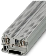
Bauelementreihenklemme, mit integrierter Diode, Nennstrom: 1,5 A, Anschlussart: Zugfederanschluss, Bemessungsquerschnitt: 4 mm<sup>2</sup>, Querschnitt: 0,08 mm<sup>2</sup> - 6 mm<sup>2</sup>, Montage: NS 35/7,5, NS 35/15, Farbe: grau
