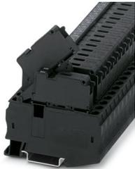
Sicherungsreihenklemme, Art der Sicherung: Glas / Keramik / ..., Sicherungstyp: G / 6,3 x 32, Nennspannung: 60 V, Nennstrom: 10 A, Anschlussart: Zugfederanschluss, 1. Etage, Bemessungsquerschnitt: 1,5 mm<sup>2</sup>, Querschnitt: 0,08 mm<sup>2</sup>- 6 mm<sup>2</sup>, Montageart: NS 35/7,5, NS 35/15, Farbe: schwarz
