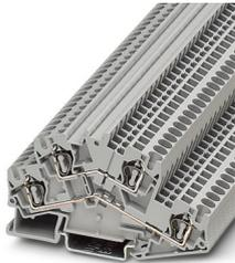
Doppelstock-Zugfederklemme, Nennspannung: 500 V, Nennstrom: 28 A, Anschlussart: Zugfederanschluss, 1. und 2. Etage, Bemessungsquerschnitt: 4 mm<sup>2</sup>, Querschnitt: 0,08 mm<sup>2</sup> - 6 mm<sup>2</sup>, Montageart: NS 35/7,5, NS 35/15, Farbe: grau
