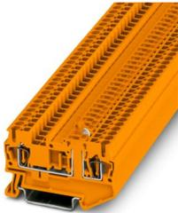
Messertrennklemme, Nennspannung: 400 V, Nennstrom: 20 A, Anschlussart: Zugfederanschluss, Bemessungsquerschnitt: 2,5 mm<sup>2</sup>, Querschnitt: 0,08 mm<sup>2</sup> - 4 mm<sup>2</sup>, Montage: NS 35/7,5, NS 35/15, Farbe: orange
